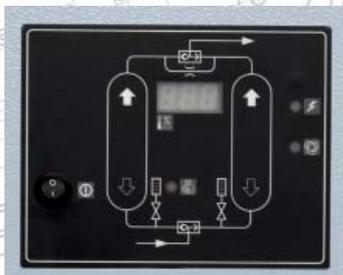
Осушители адсорбционного типа используют часть сжатого воздуха для продувки насыщенного влагопоглотителя. В обычных адсорбционных осушителях продувка происходит через определенные промежутки времени, при этом влагопоглотитель может быть не до конца насыщен, что приводит к излишнему энергопотреблению.
